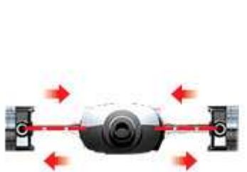
Ležatý motor s protiběžnými písty
